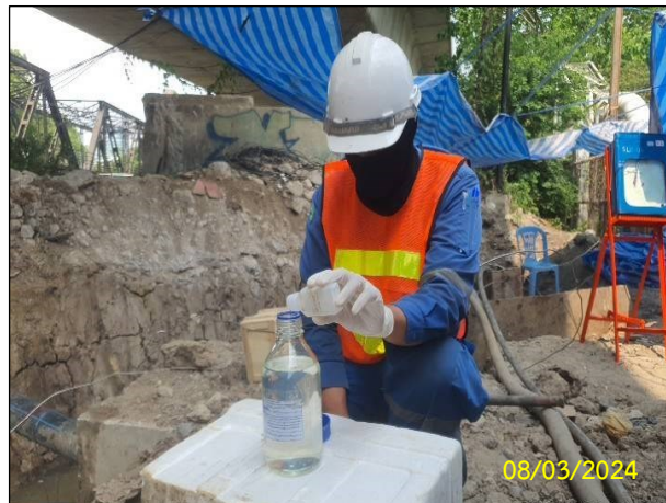
บริเวณ SECTION 1 : HDD 4.1 ค) กิจกรรมการเก็บตัวอย่างคุณภาพน้ำจากการทดสอบท่อด้วยวิธีทางชลสถิต (Hydrostatic Test)
